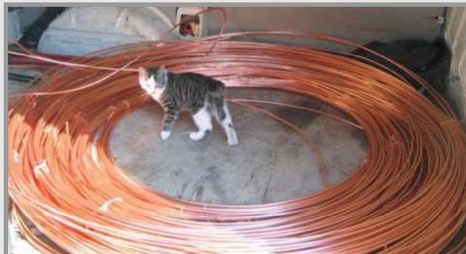
**Kupferdraht, acht Millimeter stark, ist das Ausgangsmaterial. Sie bezieht ihn von LEONI Kabel in Roth.**
